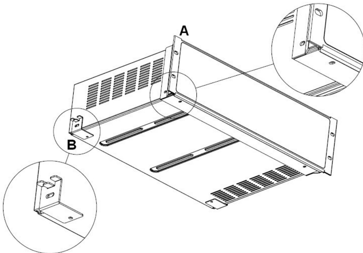
**1** Rimuovere i quattro piedini di gomma dalla parte inferiore dell'amplificatore.
