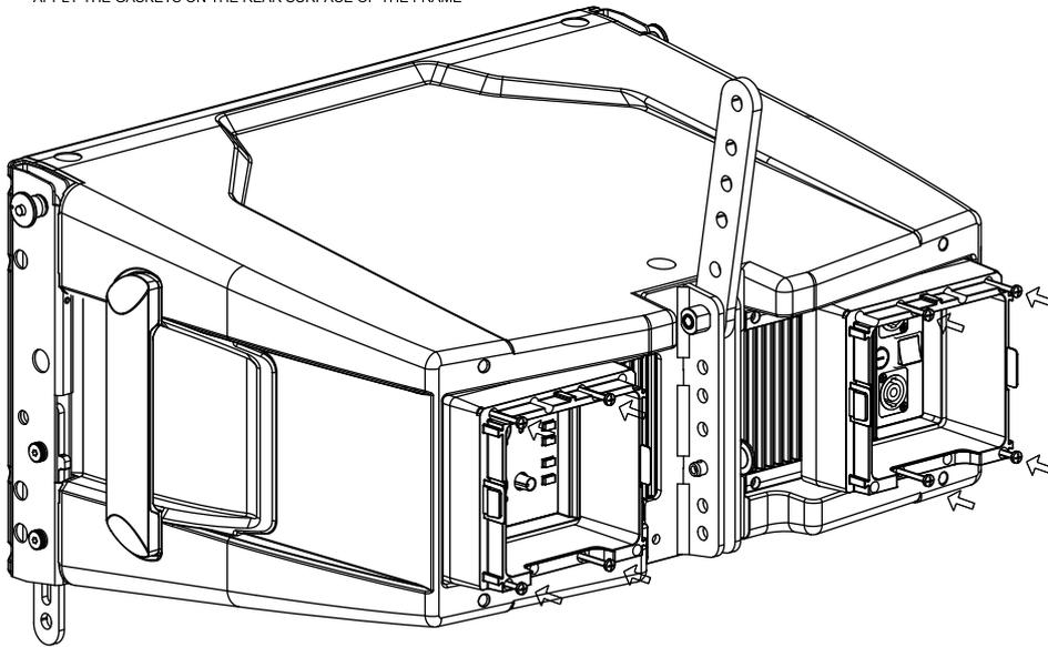
RIMUOVERE LE 8 VITI LATERALI DELL'AMPLIFICATORE, APPLICARE LE CRONICI E FISSARLE CON LE VITI IN DOTAZIONE ALL'ACCESSORIO.
