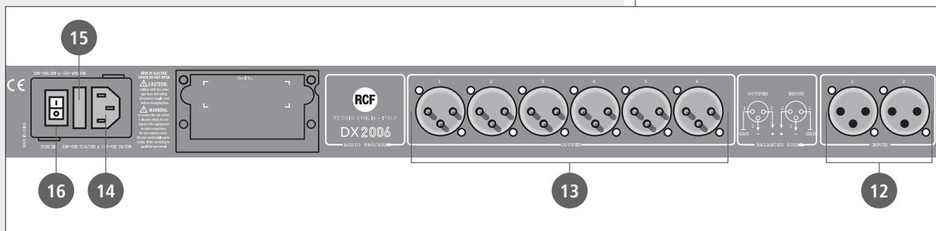
12 **INPUTS** – Ingressi audio bilanciati (analogici) con connettori XLR tripolari femmine.
