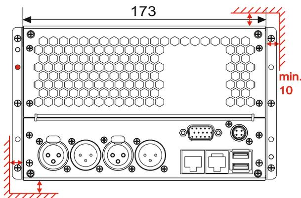
3 | Rückansicht (Maße in mm, Toleranz:  $\pm 0,5$  mm)
