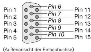
**HINWEIS** - Die Länge des VGA-Kabels beträgt max. 15 m!
