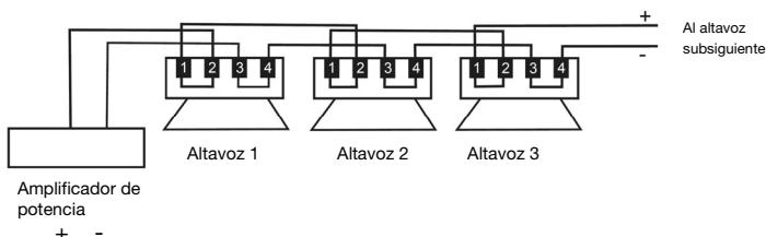
6. Inserte el conector Euroblock precableado, asegurándose de estar utilizando la polaridad correcta.
