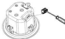
5. Utilisez les bornes de câblage fournies (voir graphique ci-dessous). Lorsque cette méthode de câblage est utilisée, vous devez être savoir que lorsqu'une enceinte n'est pas branchée une connexion vers d'autres enceintes n'est pas possible. Une autre solution consiste à raccorder les câbles entrants et sortants en parallèle. La broche 2 est + et la broche 3 est - (voir graphiques ci-dessous).
