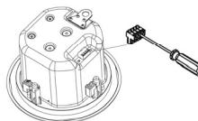
5. Verwenden Sie die vorgesehenen Durchschleifanschlüsse (siehe Grafik unten). Bei dieser Verdrahtungsmethode muss Ihnen bewusst sein, dass keine weiteren Lautsprecher angeschlossen werden können, wenn ein Lautsprecher nicht angeschlossen ist. Eine Alternative dazu wäre, eingehende und abgehende Kabel parallel zu verdrahten. Pin 2 ist + und Pin 3 ist - (siehe Grafik unten).
