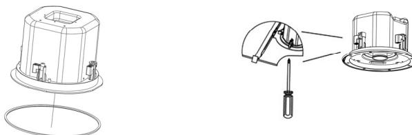
8. Verwenden Sie einen Schlitzschraubendreher, um den Wahlschalter so zu drehen, dass der Pfeil auf die richtige Leistungseinstellung zeigt. Beachten Sie, dass es getrennte 70V und 100V Skalen gibt, was von der verwendeten Netzspannung abhängt (siehe Grafik unten). Der Transformator kann auch überbrückt werden, indem die 16-Ohm-Position gewählt wird. Am besten setzen Sie den Grill erst ein, wenn die Leistungseinstellung abgeschlossen ist, falls Anpassungen nötig sind.
