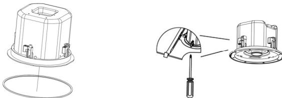
8. Utilice un destornillador plano para girar el selector de voltaje de manera que el ajuste de corriente correcto quede junto a la flecha. Observe que hay escalas de 70 y 100 V separadas, dependiendo del voltaje de línea que se esté utilizando (vea el gráfico a continuación). También puede puentearse el transformador seleccionando la posición correspondiente a 16 ohm. Puede que sea preferible dejar la rejilla afuera hasta terminar el ajuste de voltaje en caso de tener que realizar ajustes.
